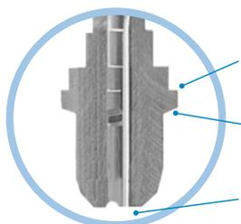
Ступенчатая грань указывает на положение шейки имплантата
